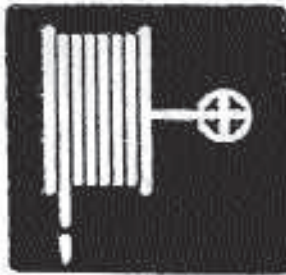
Agulheta de incêndio
