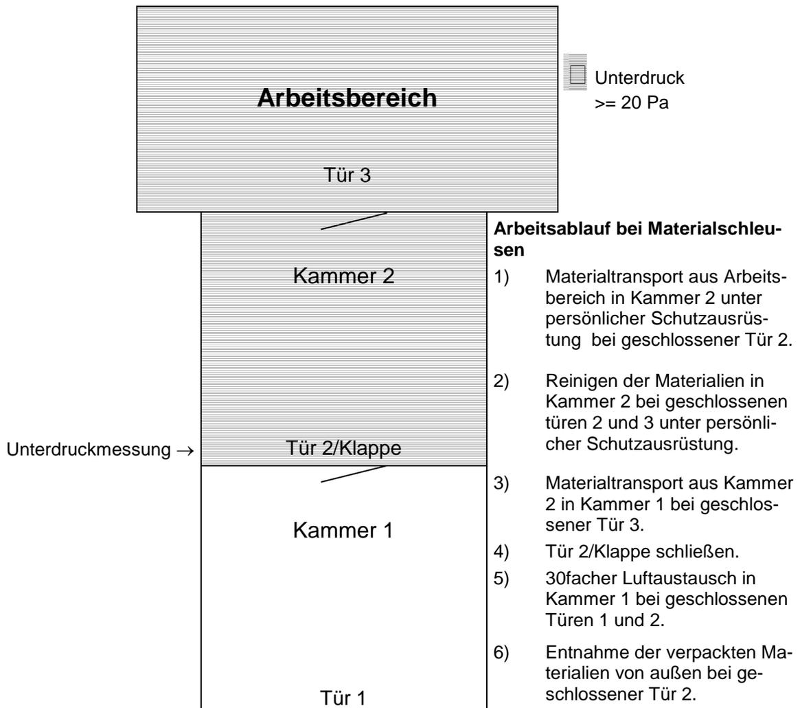
Abb. 2: Materialschleuse (Prinzipskizze)
