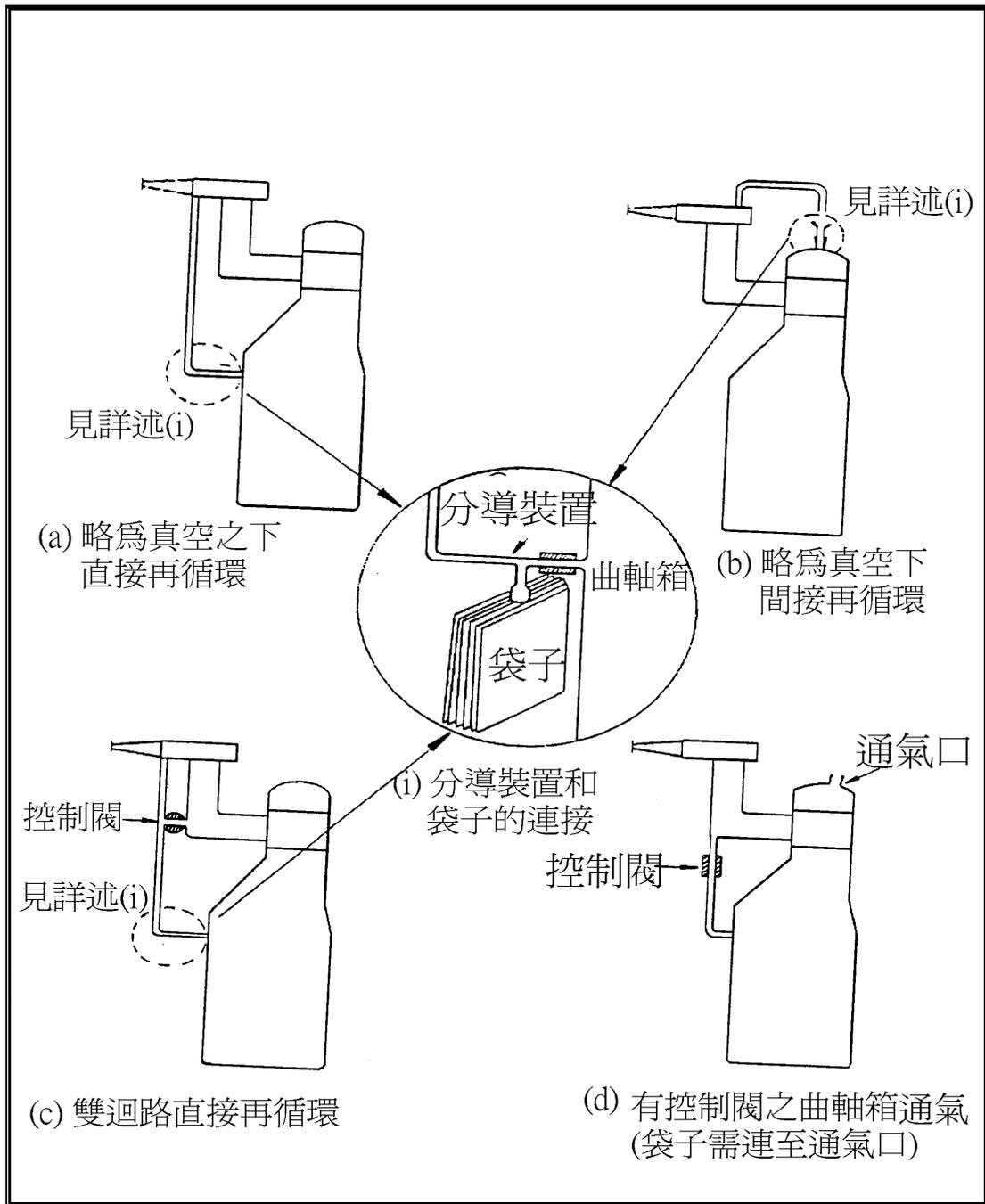
圖二 曲軸箱測試—額外測試方法
